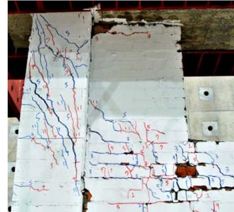
側位移比1.5%，邊柱剪力裂縫快速發展
