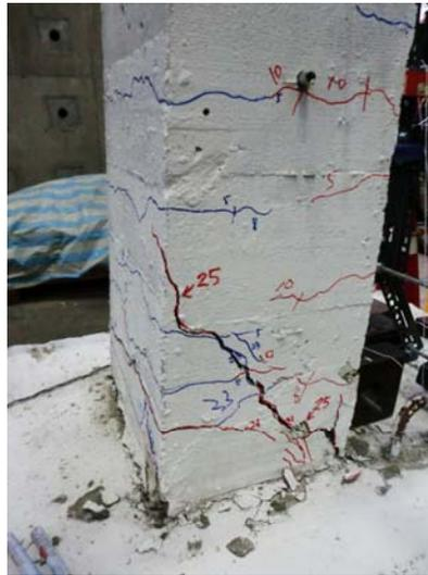
柱底處生45度剪力斜裂縫 (4.5%)
