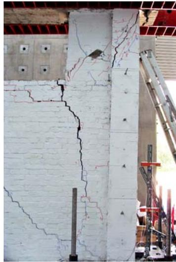
側位移比1.25%，新增之RC翼牆與短柱剪力裂縫延伸切過
