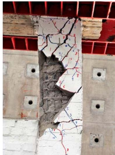
側位移比2%，試體達到極限牆度
