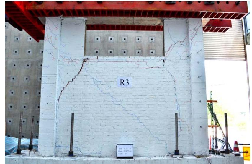
側位移比0.75%，磚牆形成一道完整裂隙且試體達水平側向力最大值
