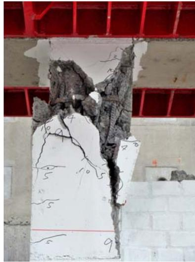
側位移比1.75%，核心混凝土嚴重損壞
