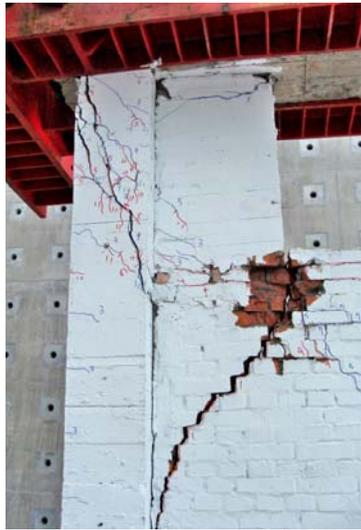
側位移比1.75%，紅磚受壓擠碎崩落
