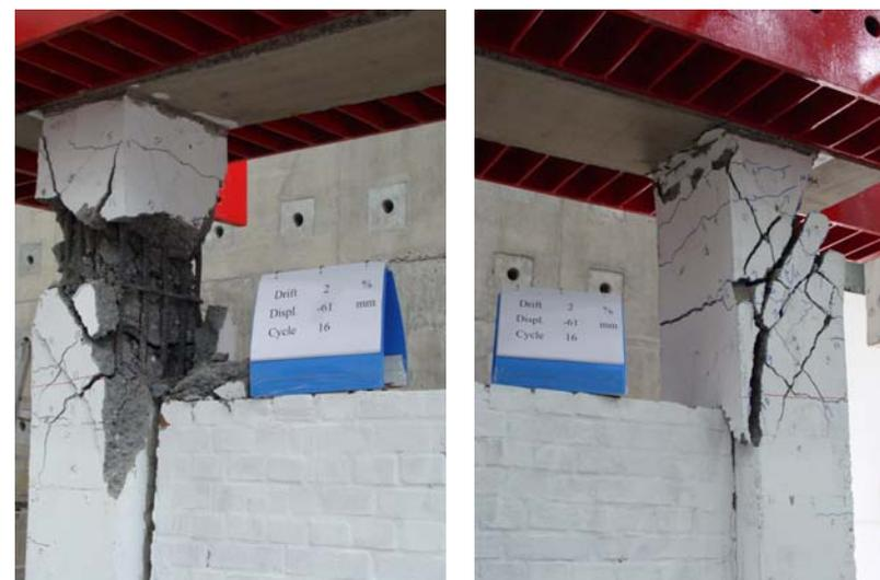
側位移比2%，在短柱區域中央之核心混凝土嚴重破損
