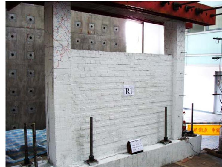
構架短柱區域剪力裂縫快速發展 (0.75%)
